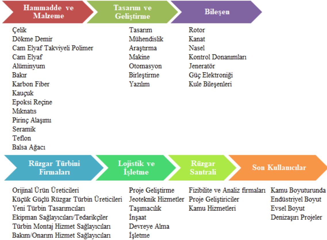
Şekil 3.29. Rüzgar endüstrisi detaylı deđer zinciri
